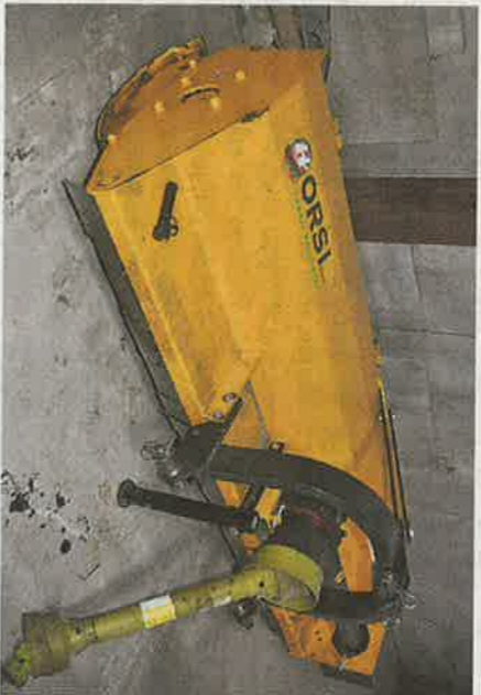
Brakpudseren bruges til at vedligeholde vedvarende græsarealer. Der står altid planter tilbage som tidsler og lyssev, som dyrene ikke gider æde. Og da der gives tidskud til naturarealer, som ikke må sprøjtes, er brakpudseren en nødvendighed.
